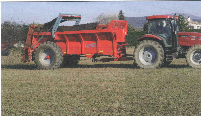
L'épandeur de 13m 3 de la cuma de Redan est équipé d'un DPA et d'un système de pesée intégré. Acheté en 2011, il épand 4 000 t/an de fumier.
