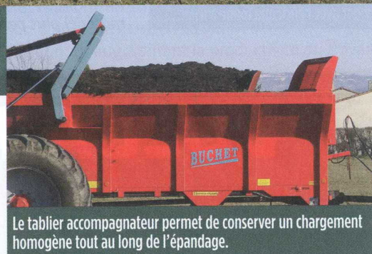
L'épandeur de 13m 3 de la cuma de Redan est équipé d'un DPA et d'un système de pesée intégré. Acheté en 2011, il épand 4 000 t/an de fumier.
